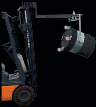
KIT PARA VACIAR EL CONTENEDOR
