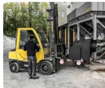
Sistema de descarga basculante
