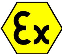
Das Gerät mit der Kennzeichnung II 1/3 D Ex htc IIIC T140 ° C Da / Dc kann eine ZONE 20 enthalten und kann in ZONE 22 verwendet werden
