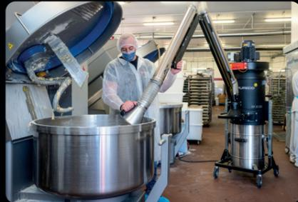
**Der Entstauber saugt an der Quelle an, um die Arbeitsumgebung und die Bediener zu schützen.**
