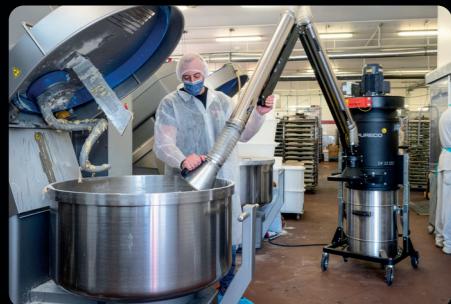
Aspiración en origen para proteger el entorno de trabajo y a los operadores.
