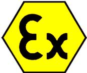
Die Geräte mit der Kennzeichnung **II 1/3 D Ex htc IIIC T140 °C Da/Dc** können im Inneren eine ZONE 20 enthalten und in ZONE 22 verwendet werden
