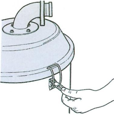
Wenn sich Feststoffe im Filter befinden oder der Filter Löcher aufweist, kann die gesamte Filtereinheit mit den entsprechenden Griffen angehoben, der Filter herausgezogen und der Filterhalter gereinigt werden.
