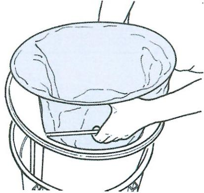
Den Filtereinsatz spülen, den neuen Filter einsetzen und alles wieder im Innern des Fachs montieren, den Deckel anbringen und festklebmen.
