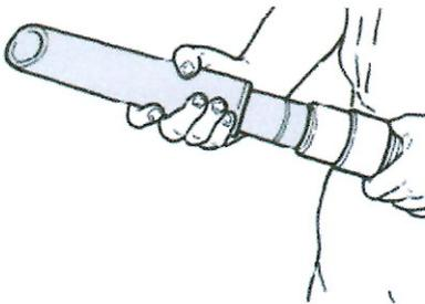
An der Kupplung des Saugschlauchs das für die auszuführende Arbeit gewählte Zubehörteil anbringen.
