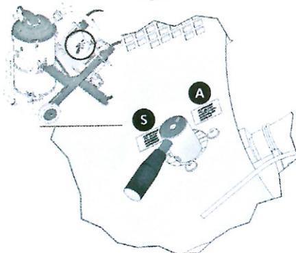
Der Stellhebel des Saugventils ist in der Abbildung gezeigt und kann auf SAUGEN (ASPIRARE - "A") oder auf BLASEN (SOFFIARE - "S") gestellt werden.
