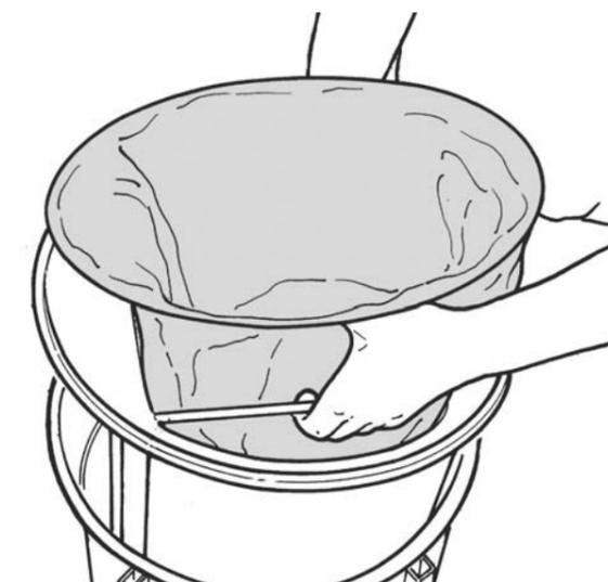
Sciacquare il portafiltro, inserire il nuovo filtro e rimontare il tutto all'interno del vano, rimontando e bloccando il coperchio.
