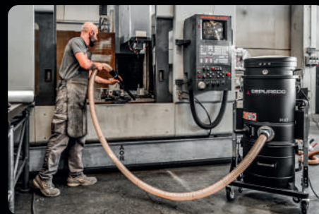
Limpeza de virutas metálicas de máquina CNC
