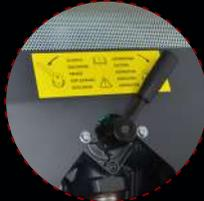
Sistema de descarga con inversión de flujo
