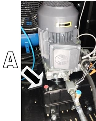
**ÖL DES HYDRAULIKAGGREGATS: ISO VG 32**
