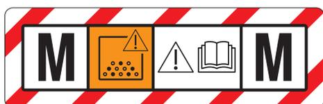
Dieser Aufkleber zeigt an, dass das Gerät Staub bis zur Klasse M aufsaugen kann.
