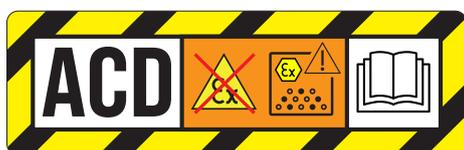
Dieser Aufkleber weist darauf hin, dass das Gerät brennbare Stäube in nicht nach ATEX klassifizierten Bereichen absaugen kann (für bestimmte Modelle und Versionen).
