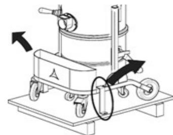
Nehmen Sie das Gerät mit Hilfe einer Rampe mit geeigneter Tragfähigkeit von der Plattform und führen Sie den Staubsauger am Griff ab.
