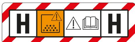
Dieser Aufkleber zeigt an, dass das Gerät Staub bis zur Klasse H aufsaugen kann.
