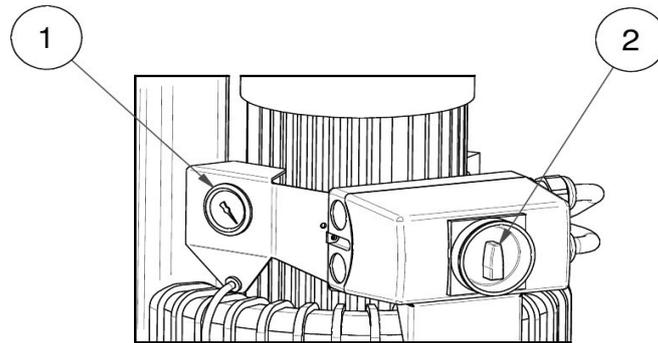
1. das Vakuummeter **FILTERVERSTOPFUNG**
