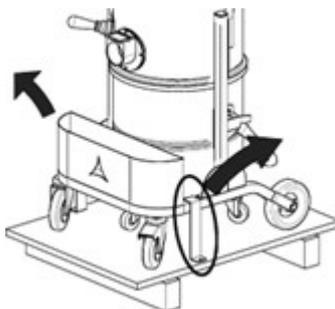
Rimuovere la macchina dalla pedana di sostegno aiutandosi con una rampa di portata adeguata e conducendo l'aspiratore dal manico.
