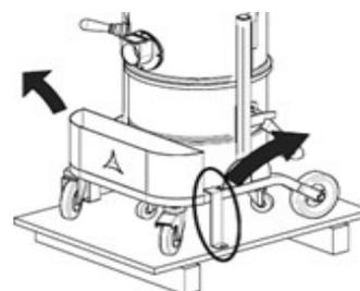
Rimuovere la macchina dalla pedana di sostegno aiutandosi con una rampa di portata adeguata e conducendo l'aspiratore dal manico.
