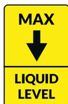
Dieser Aufkleber zeigt den maximalen Flüssigkeitsstand im Behälter an (für Modelle und Versionen, falls zutreffend).
