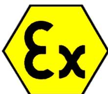
Les équipements portant le marquage **II 1/3 D Ex htc IIIC T140°C Da/Dc** peuvent contenir une ZONE 20 à l'intérieur et peuvent être utilisés dans la ZONE 22 Les équipements portant le marquage **II 1/2 D Ex h tb IIIC T140°C Da/Db** peuvent contenir une ZONE 20 à l'intérieur et peuvent être utilisés dans la ZONE 21 et la ZONE 22 Les zones sont définies comme suit
