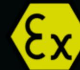
La **torba** è un materiale organico ricco di carbonio e **altamente combustibile**. Durante le fasi di lavorazione, la manipolazione e la movimentazione della torba generano polveri fini che, se disperse nell'ambiente, possono creare atmosfere potenzialmente esplosive.
