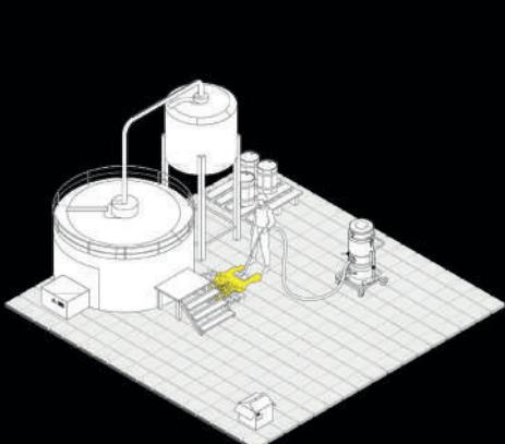
**Brennbare Stäube außerhalb einer ATEX-Zone 22:** Zubehör und Industriesauger innerhalb eines nicht ATEX-Bereichs.
