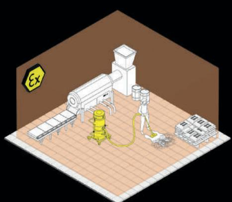
**Brennbare oder nicht brennbare Stäube innerhalb einer ATEX-Zone 22:** Zubehör und Industriesauger innerhalb des ATEX-Bereichs.
