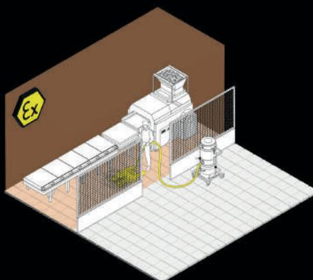
**Brennbare Stäube innerhalb einer ATEX-Zone 22:** Zubehör innerhalb, Industriesauger außerhalb der ATEX-Zone.
