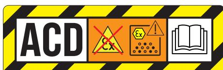
Este adhesivo indica que la unidad puede aspirar polvos combustibles en zonas no clasificadas ATEX (para modelos y versiones específicos).
