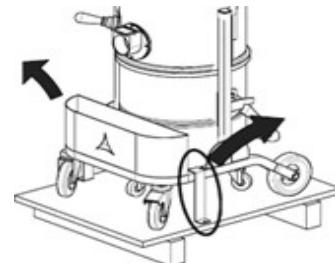
Retire la máquina de la plataforma de apoyo con la ayuda de una rampa de capacidad adecuada y guíe el aspirador desde el asa.
