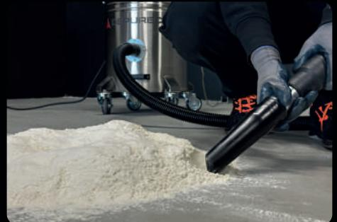
Les aspirateurs industriels ACD sont conçus pour garantir une sécurité maximale dans la gestion des poussières combustibles dans les zones non classées.
