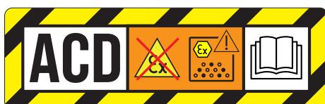
Cet autocollant indique que l'appareil peut aspirer des poussières combustibles dans des zones non classées ATEX (pour les modèles et versions dédiés).
