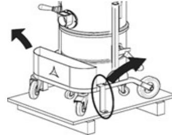
Rimuovere la macchina dalla pedana di sostegno aiutandosi con una rampa di portata adeguata e conducendo l'aspiratore dal manico.
