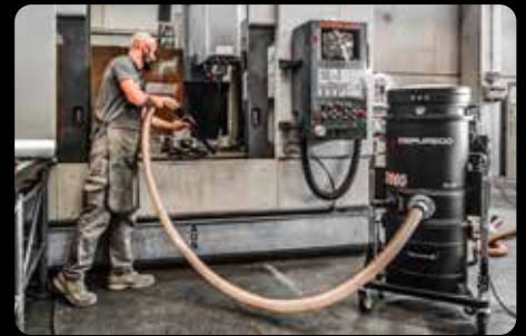
Sammlung von Metallspänen aus CNC-Maschinen
