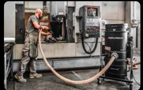
Limpeza de virutas metálicas de máquina CNC
