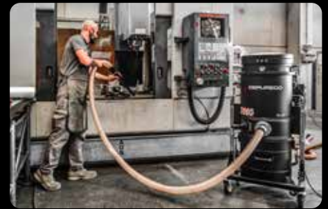
Récupération des copeaux métalliques des machines à commande numérique
