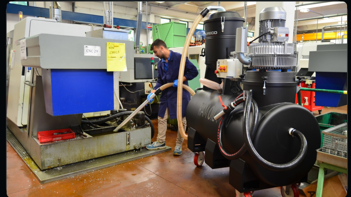
Aspiración durante el mantenimiento de una máquina CNC
